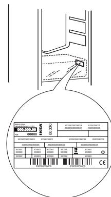
Technické údaje jsou uvedeny na typovém štítku umístěném na uvnitř spotřebiče a na energetickém štítku.
