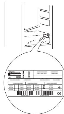
Specificațiile tehnice sunt menționate pe placuta cu datele tehnice din interiorul aparatului și pe eticheta energetică.
