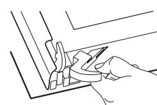
Отожмите стопоры, чтобы снять внутреннее стекло.
