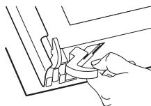
Oldja ki a rekeszelőrendszeret a belső üveglap kiszereléséhez.
