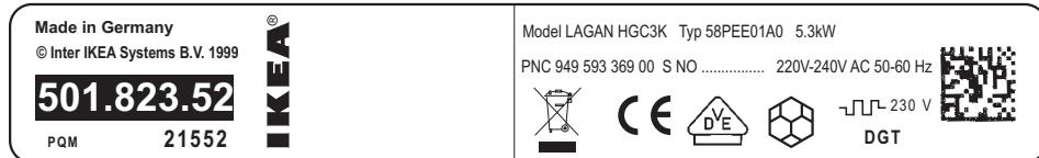
Die Grafik oben stellt das Typenschild des Gerätes dar (ohne die Seriennummer, da diese dynamisch während des Produktionsvorgangs erzeugt wird), das sich an der Gehäuseunterseite befindet.
